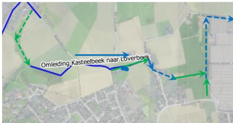
(stippellijn = bestaand ; volle lijn = ontwerp ; groen = open profiel ; blauw = ingebuisd)
